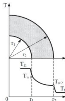
Рисунок 3 – Теплопередача через стенку шаровой формы
