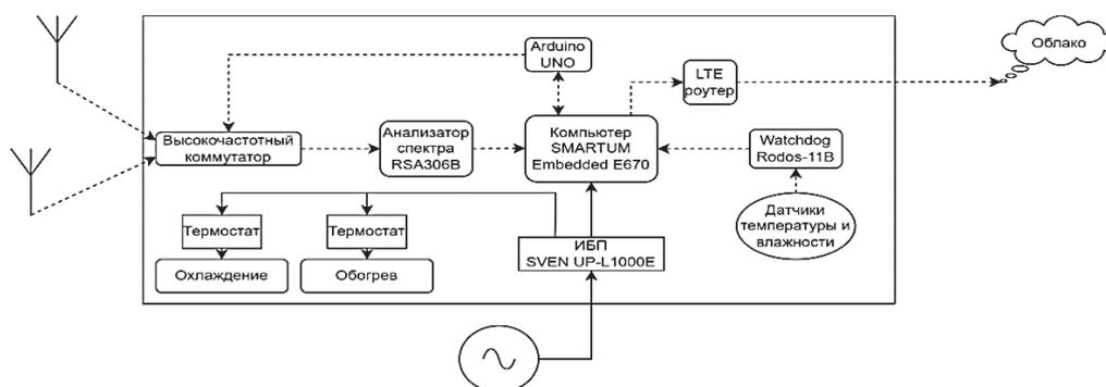
Рисунок.3 – Функциональная схема
