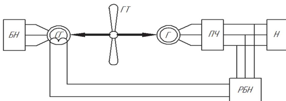
БН - балластная нагрузка; СГ - синхронный генератор; ОВ - обмотка возбуждения;
