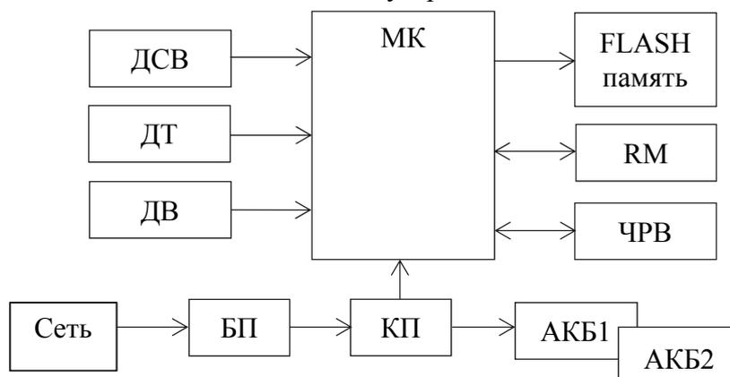
МК – микроконтроллер; ДТ – датчик температуры; ДВ – датчик влажности;
