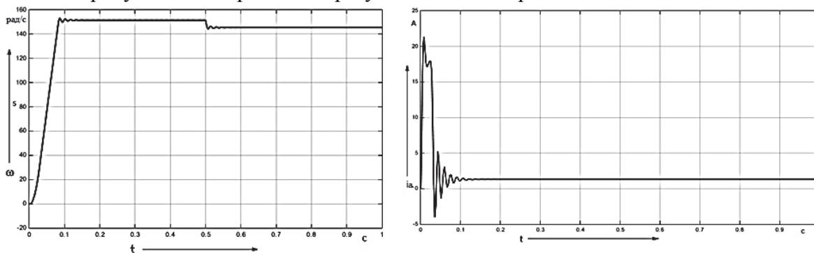
Рисунок 2 – Переходная функция скорости и тока  $i_{\alpha}$
