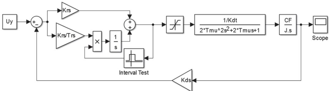
Рисунок 3 – Блок-схема контура скорости ДПТ-ТП с компенсацией условным интегрированием
