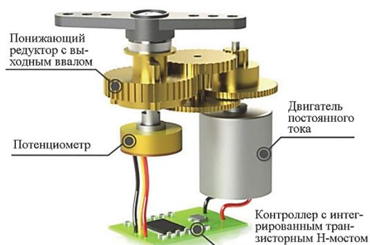
Рисунок 1 – Основные узлы сервопривода
