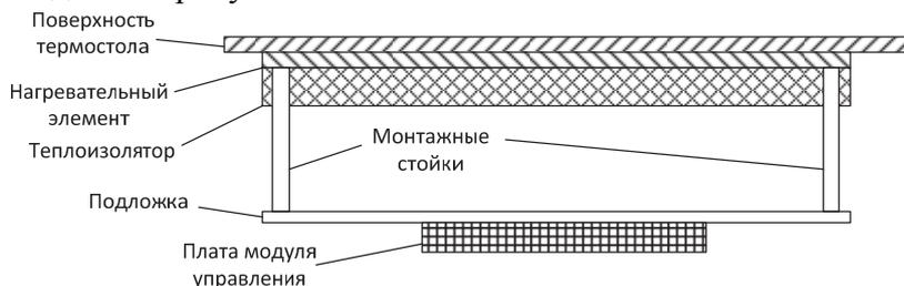
Рисунок 3 – Расположение элементов системы управления термостола
