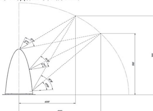
Рисунок 2 - Анализ углов между нормалью и лазерным лучом
