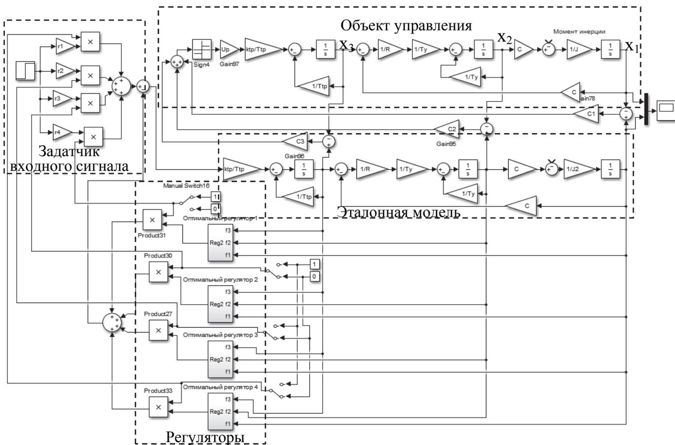
Рисунок 1 – Структурная схема модели системы с многоструктурным регулятором
