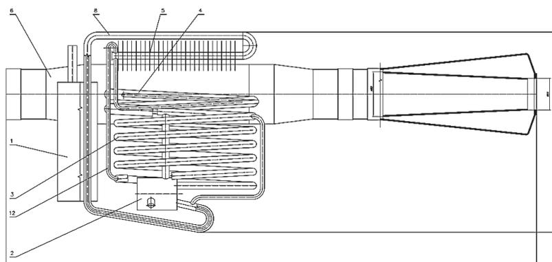
Рисунок 1 – Сборочный чертеж экокондиционера абсорбционного типа
