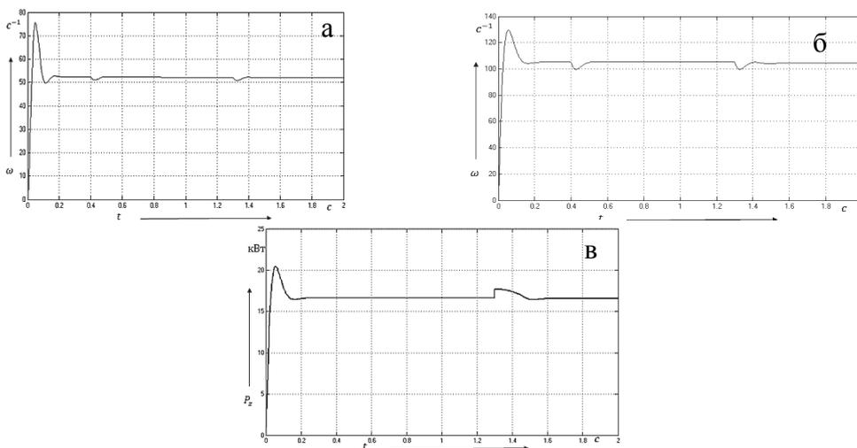
а- переходный процесс скорости привода подачи ; б – переходный процесс скорости привода главного движения; в – переходный процесс мощности резания
