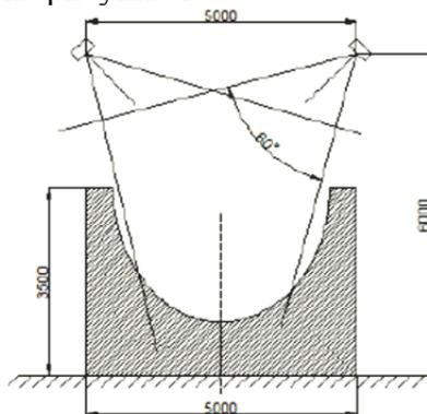
Рисунок 1 - Схематичное расположение проекторов
