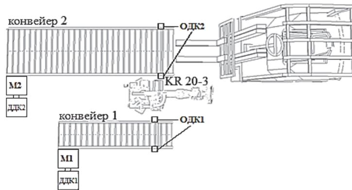
ДДК 1 – датчик движения конвейера 1; ДДК 2 – датчик движения конвейера 2;
