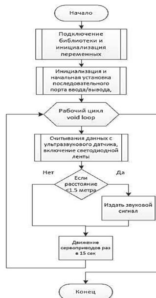
Рисунок 4 – блок-схема программы
