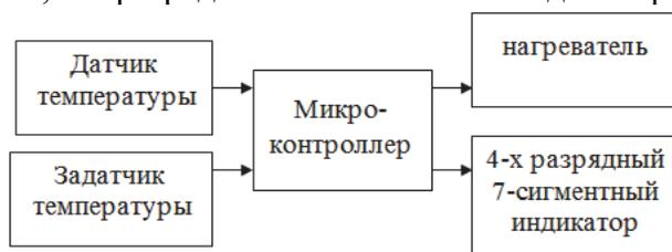
Рисунок 1 – Структурная схема системы управления печью
