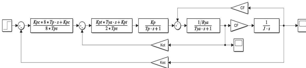
Рисунок 1 – модель системы с классическими регуляторами
