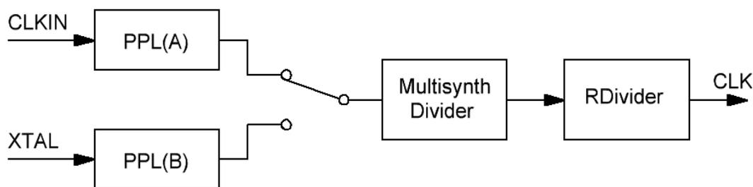
Рисунок 1 – Упрощенная структурная схема прибора Si5351
