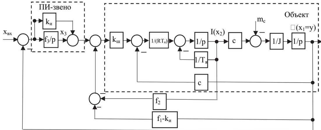
Рисунок 1 - Структурная схема электропривода с оптимальным ПИ-регулятором
