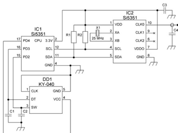
Рисунок 2 – Принципиальная схема гетеродина на микросхеме Si5351
