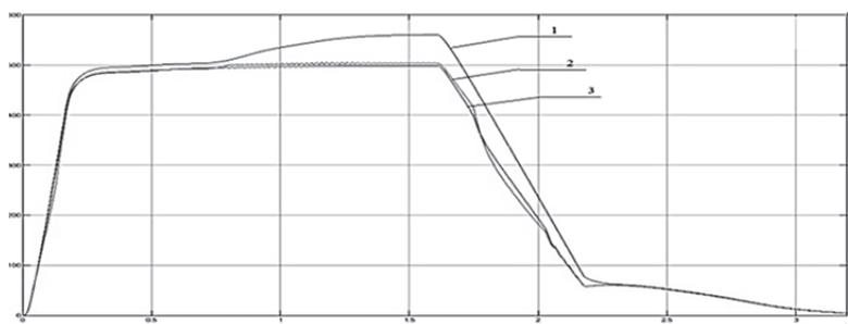
1 – Классическая система; 2 – Система с нечетким логическим регулятором (Sugeno);
