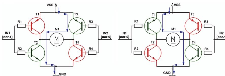
Рисунок 2 – Принцип работы H-моста на биполярных транзисторах
