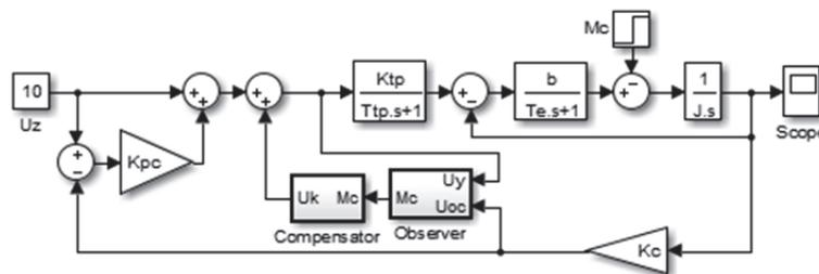
Рисунок 1 – Структурная схема системы комбинированного скалярного управления
