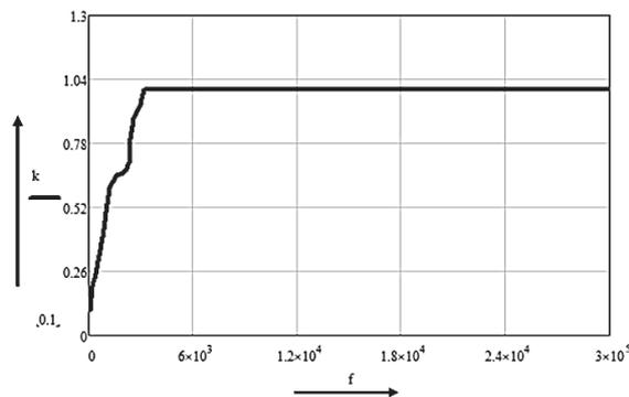
Рисунок 3 – Амплитудно-частотная характеристика трансформатора на ферромагнитном сердечнике
