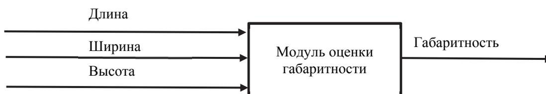
Рисунок 2 - Модель модуля оценки габаритности
