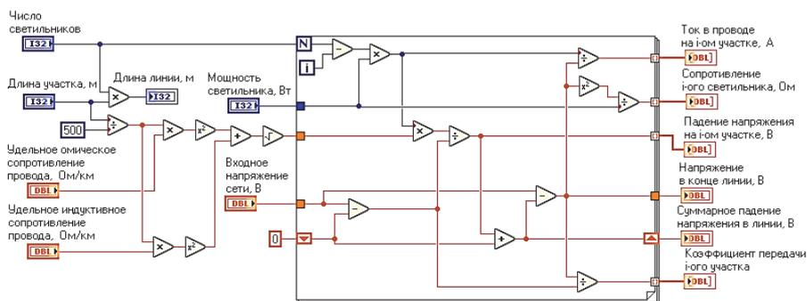
Рисунок 2 – Блок-диаграмма программы моделирования линии освещения
