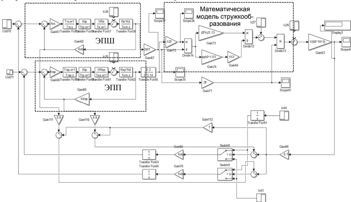
Рисунок 2 - Математическая модель адаптивной системы предельного регулирования
