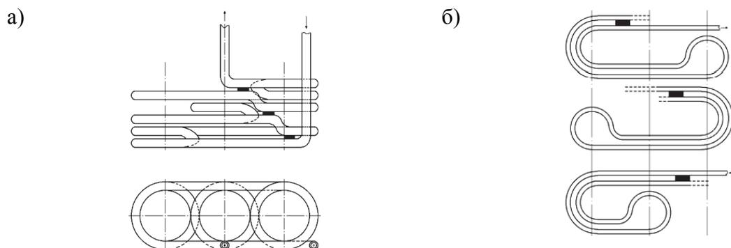
Рисунок 1 – Трубчатая обмотка с пассивным витком (а) и с бифиляром (б)
