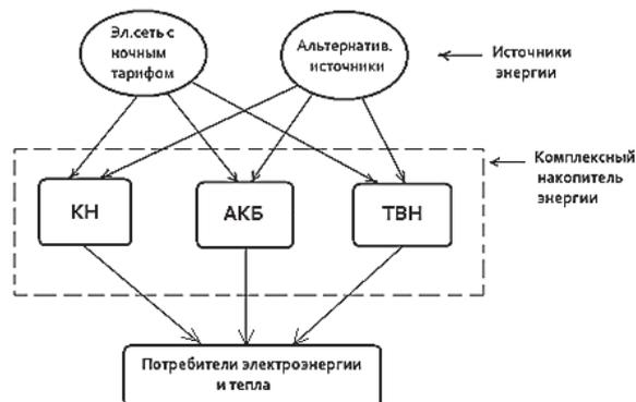
Рисунок 1 – Блок-схема компоновки комплексного накопителя энергии
