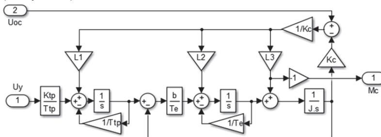
Рисунок 2 – Структурная схема наблюдателя Observer
