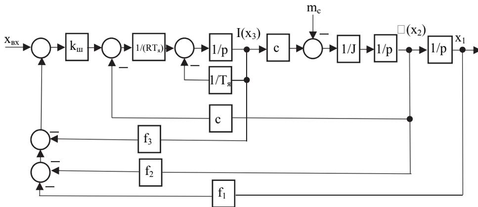
Рисунок 2 – Структурная схема электропривода с интегрирующим звеном
