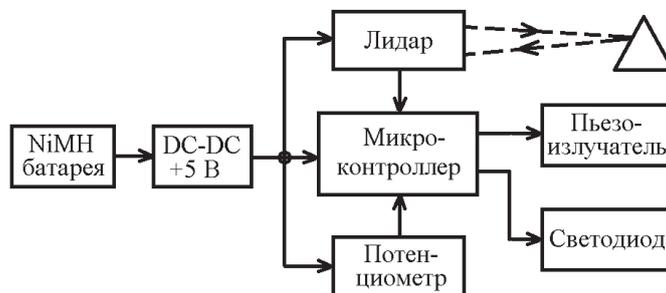
Рисунок 1 – Структурная схема дальномера со звуковой сигнализацией
