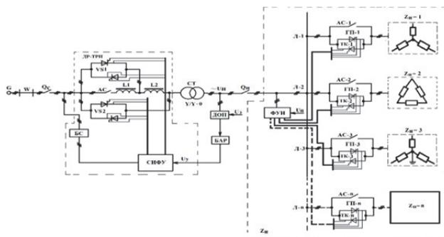
Рисунок 1 – Функциональная схема трансформаторной подстанции с двухдиапазонным реакторно-тиристорным регулятором напряжения
