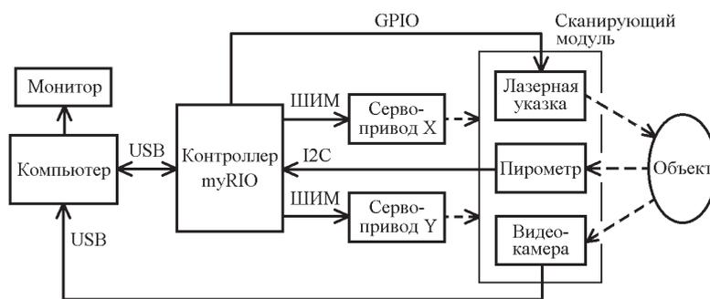
Рисунок 2 – Структурная схема тепловизора
