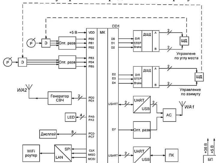
ДШД – драйвер шагового двигателя; ШД – шаговый двигатель;
