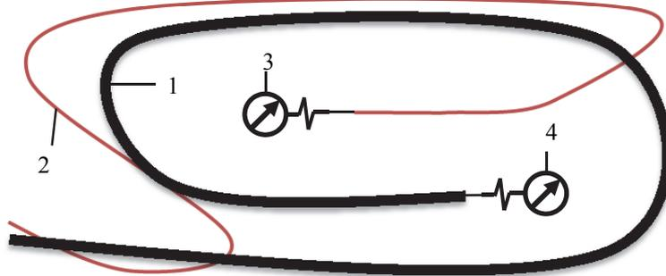
1 - канал от катушки до роликов; 2 - канал от роликов до сопла; 3, 4 - динамометры
