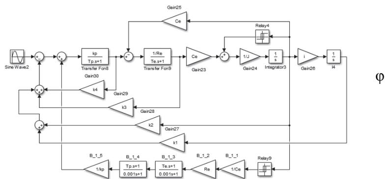
Рисунок 3 – Модель структурной схемы нелинейного модального регулятора и объекта управления в матричной форме
