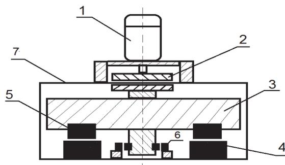
Рисунок 2 – Конструктивная схема кинетического накопителя энергии
