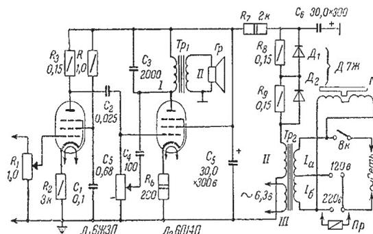
Рисунок 1 - Типовая схема лампового усилителя звуковой частоты
