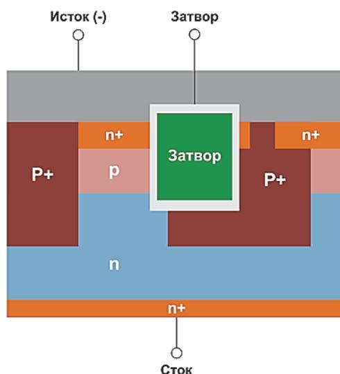
Рисунок 4 – Структура транзистора по технологии CoolSiC
