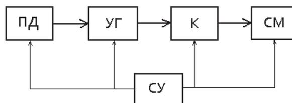
Рисунок 1 – Блок-схема основных узлов контактной сварки с униполярным генератором в качестве накопителя кинетической энергии (ПД –приводной двигатель, УГ – униполярный генератор, К – контактор, СМ – сварочная машина, СУ – система управления)
