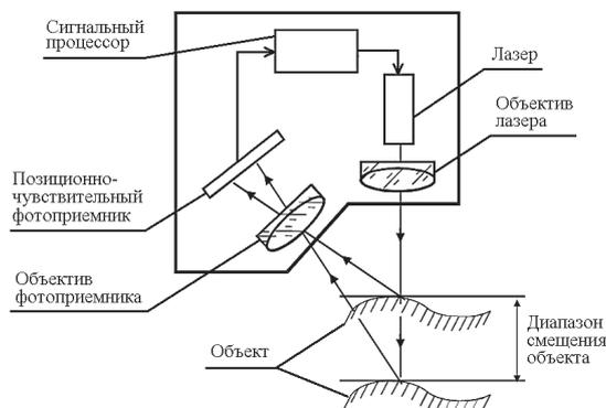
Рисунок 2 - Принцип работы оптического триангуляционного датчика
