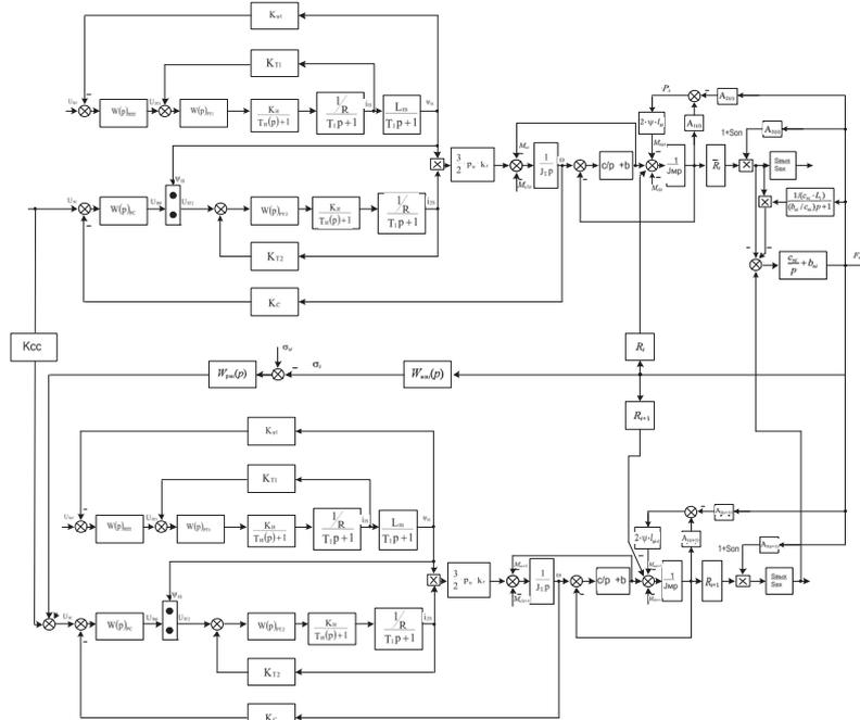
Рисунок 1 – Структурная схема математической модели силового взаимодействия электроприводов смежных клеток, объединённых металлической полосой
