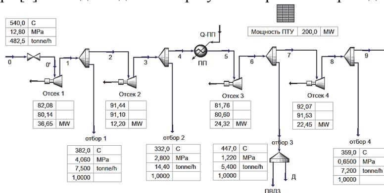
Рисунок 1 – Схема техпроцесса отсеков паровой турбины (с 1 по 4 отсек)
