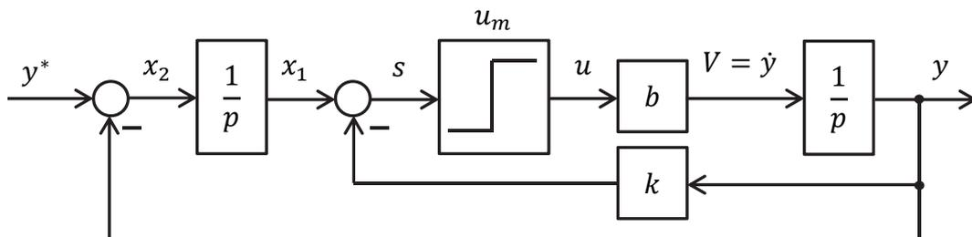
Рисунок 1 – Структурная схема релейной системы управления линейным актуатором
