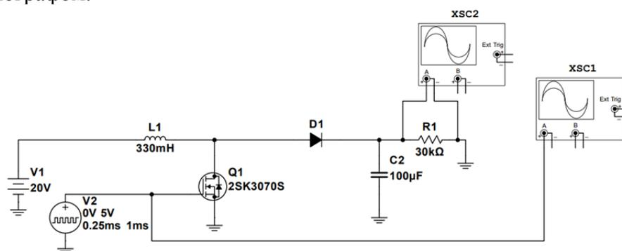
Рисунок 2 – промоделированная схема повышающего преобразователя
