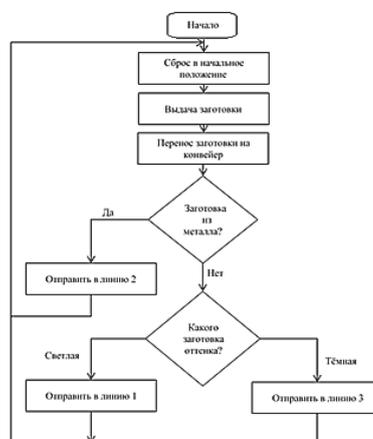
Рисунок 2 – Блок-схема алгоритма управления
