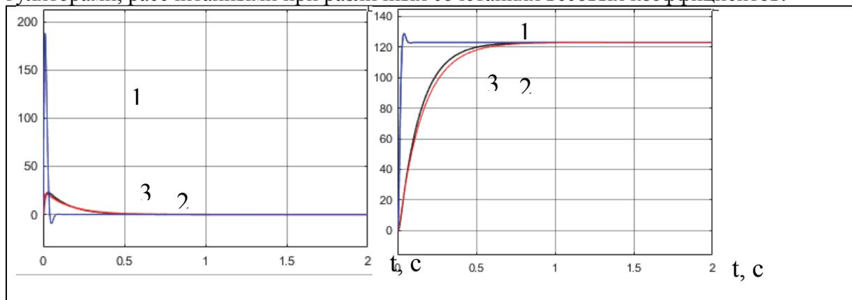
Рисунок 2 – Графики переходных процессов тока и скорости ЭП
