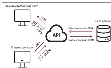
Рисунок 1 – Схема взаимодействия
