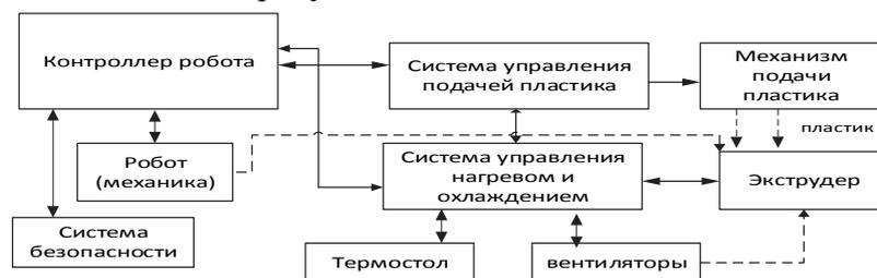
Рисунок 1 – Функциональная схема автоматизированного комплекса
