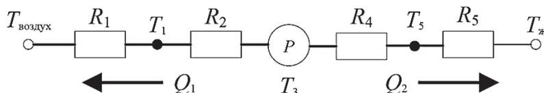
Рисунок 1 – Тепловая схема трансформатора с нагревательным блоком
