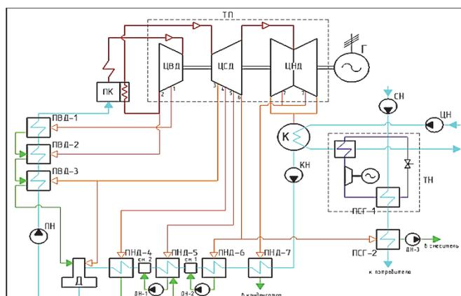
Рисунок 1 – Тепловая схема Т-180/210-130 с применением ТН
