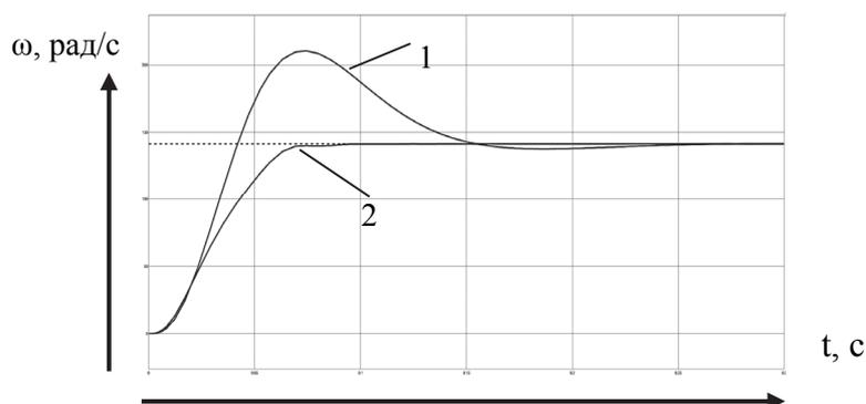
1 – Классическая система; 2 – Система с нечетким многокаскадным логическим регулятором
