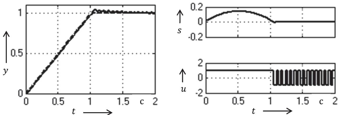
Рисунок 3 – Графики переходных процессов позиционирования штока
