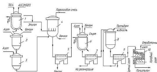
Рисунок 1 – Схема производства ПВП при низком давлении:
