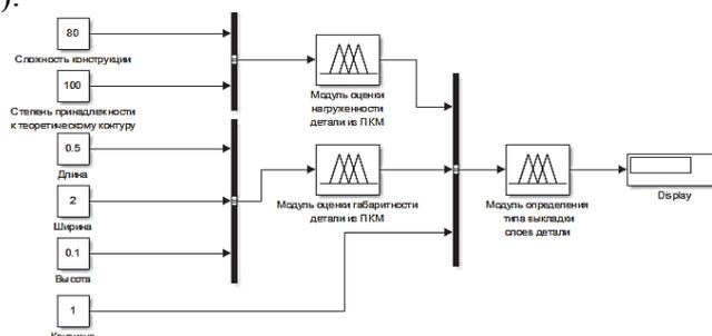
Рисунок 2 – Модель СППР в Simulink для проверки адекватности
