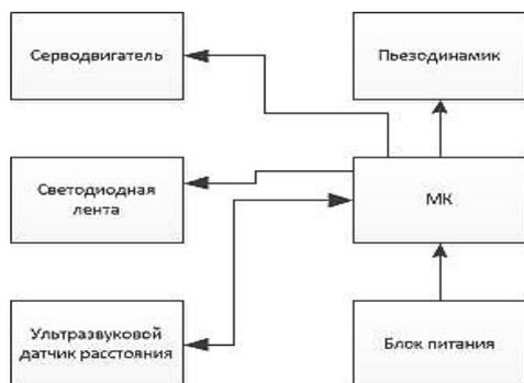
Рисунок 3 - Структурная схема подключения небольшого костюма
