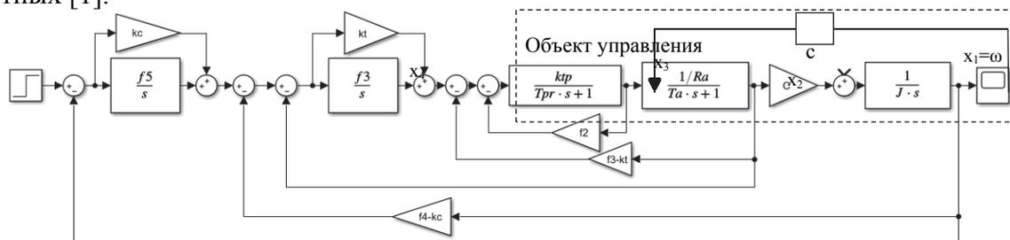
Рисунок 2 – Структурная схема системы электропривода
