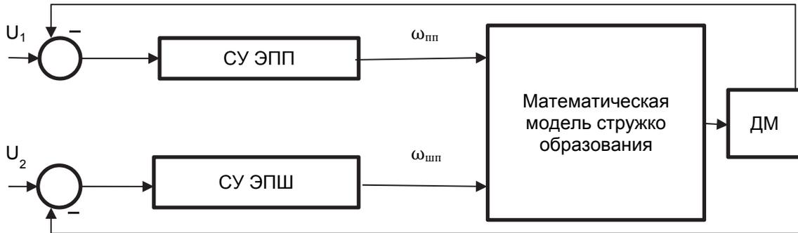
Рисунок 1 – Функциональная схема системы предельного регулирования
