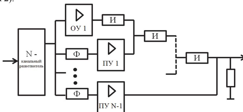
Рисунок 2 – Многоканальный усилитель по схеме Догерти
