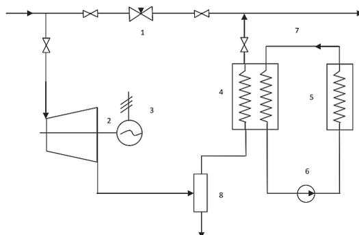
1 - редукционный клапан ГРС, 2 - детандер, 3 - электрогенератор, 4 - теплообменник, 5 - холодильная камера, 6 - циркуляционный насос, 7 - контур хладагента, 8 - сепаратор
