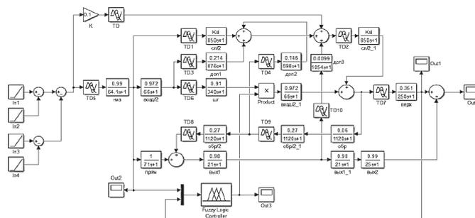
Рисунок 1 – Структурная схема пиролизной установки с нечетким логическим регулятором
