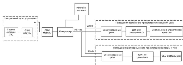
Рисунок 1 – Структурная схема энергосберегающей системы освещения
