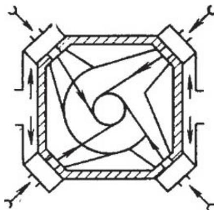
Рисунок 1 – Схема компоновки тангенциальных угловых горелок
