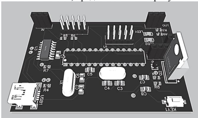
Рисунок 4 – Модель печатной платы модуля управления сегментом термостола
