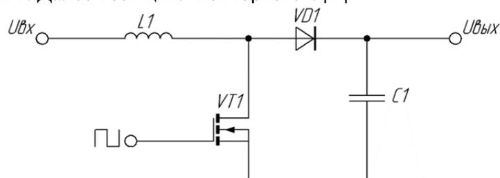
Рисунок 1 – Принципиальная электрическая схема преобразователя
