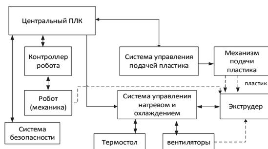
Рисунок 2 – Функциональная схема автоматизированного комплекса с ведомым контроллером робота
