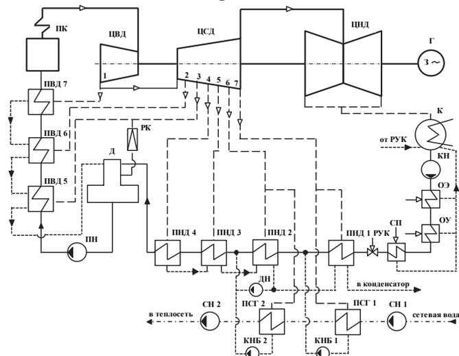
Рисунок 1 – Принципиальная тепловая схема турбины Т-100-130
