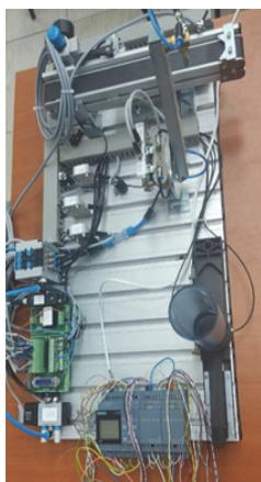
Рисунок 1 – Распределительная станция
