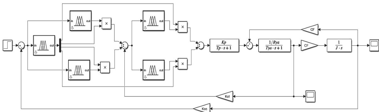
Рисунок 3 – Модель системы с многокаскадным нечетким регулятором
