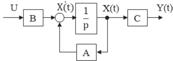
Рисунок 1 – Структурная схема объекта управления в матричной форме
