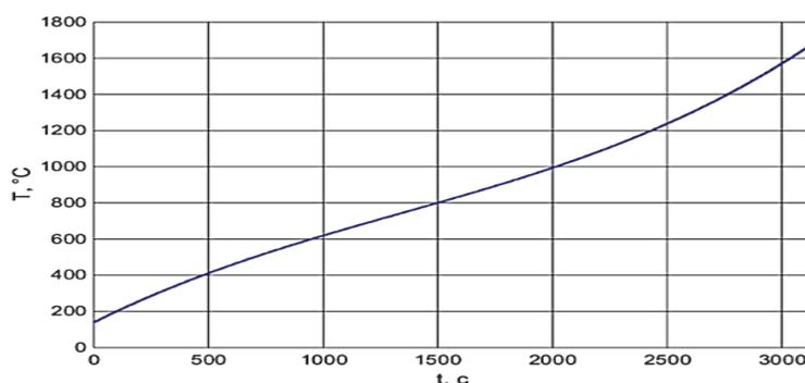
Рисунок 2 – Изменение температуры за период плавки в ДСП
