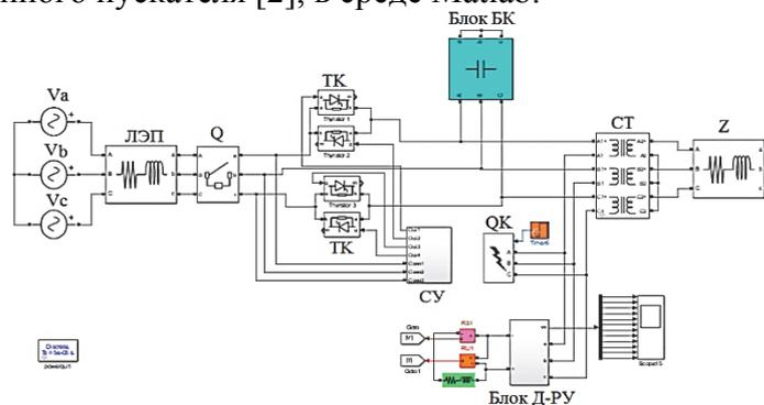
Рисунок 2 – Блочно-модульная модель силового трансформатора с электронно-электрическим пускателем
