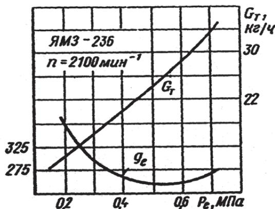
Рисунок 1 - Нагрузочная характеристика двигателя ЯМЗ – 236
