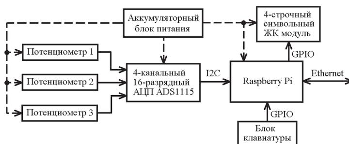
Рисунок 3 - Структурная схема измерителя геометрии колесных пар
