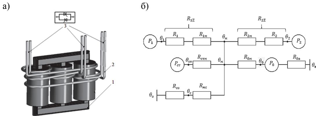
Рисунок 1 – Активная часть трансформатора с блоком нагрева (а) и эквивалентная тепловая схема замещения (б)
