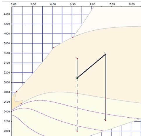
Рисунок 1 – Теоретическое расширение пара в турбине без промперегрева и с промперегревом
