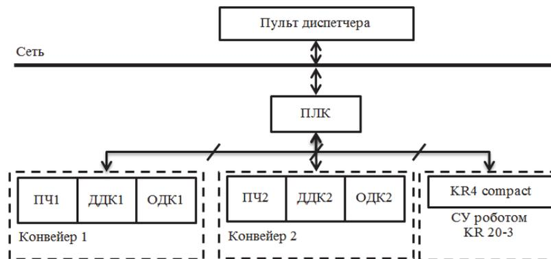
Рисунок 2 – Аппаратная конфигурация системы управления участком паллетирования
