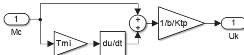
Рисунок 3 – Структурная схема компенсатора влияния статического момента Compensator
