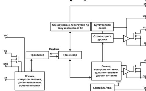
Рисунок 3 – Цепи изоляции и защиты SIC1182K
