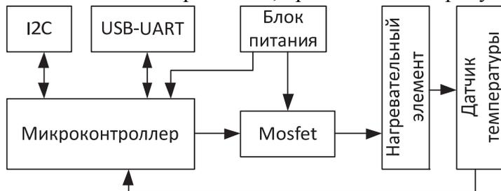
Рисунок 3 – Функциональная схема модуля управления отдельным сегментом термостола
