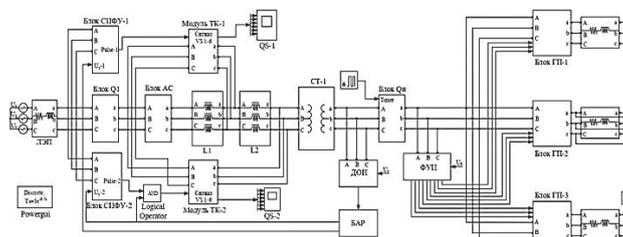
Рисунок 2 – Блочнo-модульная модель трансформаторной подстанции с предлагаемым регулятором напряжения
