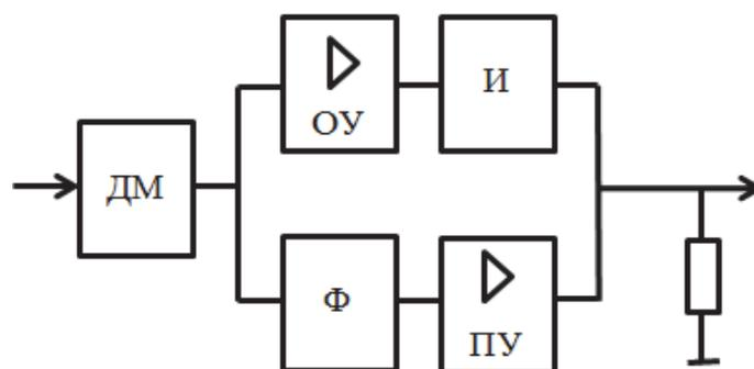
ДМ – делитель мощности; ОУ – основной усилитель, ПУ – пиковый усилитель;
