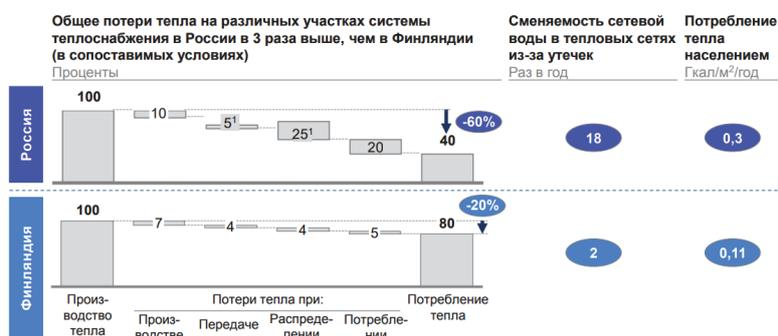
Рисунок 3 – Потери в тепловых сетях в сравнении с Финляндией
