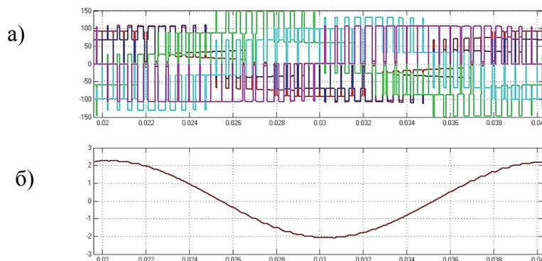
Рисунок 5 – Осциллограммы напряжений (а) и тока (б) вторичных обмоток ТВМП при несимметричной активной нагрузке
