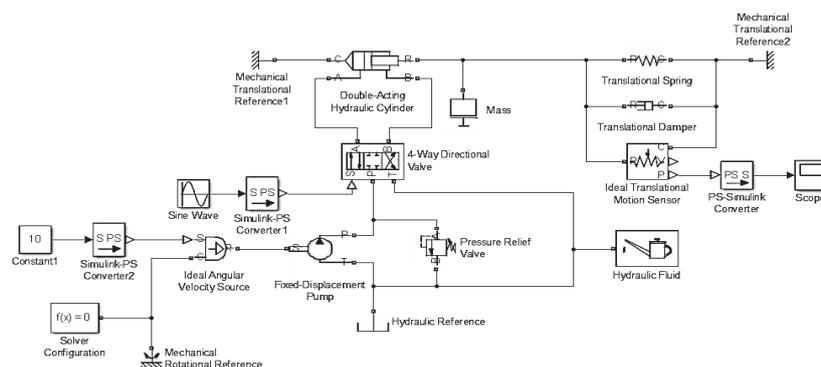
Рисунок 3 – Модель гидропривода в среде Simulink
