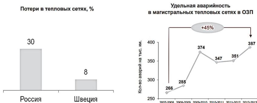
Рисунок 2 – Потери в тепловых сетях
