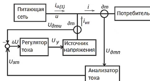
Рисунок 1 – Компенсация реактивной мощности и мощности искажения
