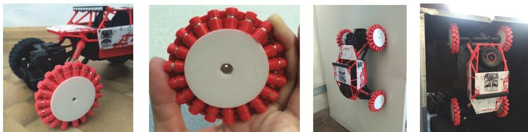
Рисунок 2 – Готовая машинка с магнитными колесами
