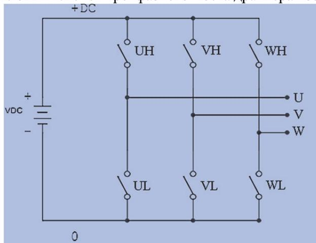
Рисунок 5 – Схема силовой части трёхфазного инвертора
