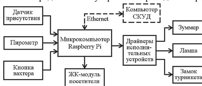
Рисунок 1 – Структурная схема устройства управления турникетом
